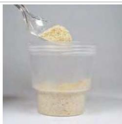
1. Pesar uma sub-amostra de **25 gramas** e colocar em um copo com tampa
