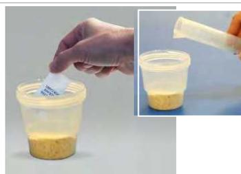
2. Adicionar um envelope de pó de extração EB17 e em seguida, **75 mL** de água (destilada, deionizada ou mineral)
