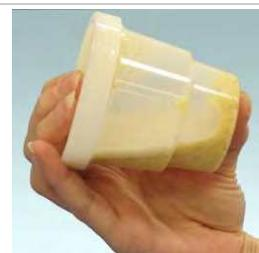
3. Agitar imediatamente por 10 segundos para dissolver o pó e em seguida, por 1 minuto em um agitador mecânico ou manualmente por 2 minutos
