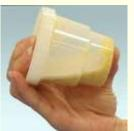
Agitar a amostra por I minuto em agitador mecânico ou manualmente por 2 minutos, vigorosamente.
