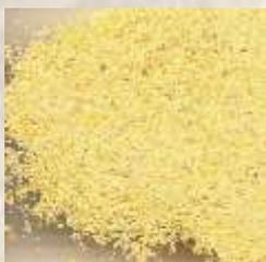
1. Coletar e moer uma amostra representativa com granulometria referente a peneira de 20 mesh (0,85mm).
