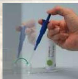
7. Transferir 200 µl da amostra diluída (passo anterior) para um novo tubo de reação.
