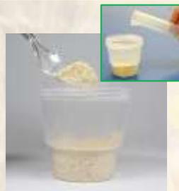
2. Adicionar a sub-amostra de 20-50 gramas em um copo com tampa; em seguida, dependendo da amostra a ser testada, adicionar 4, 5 ou 6 ml/g de água mineral, destilada ou deionizada à temperatura ambiente. (por exemplo: milho: 20 g x 5 = 100 ml)
