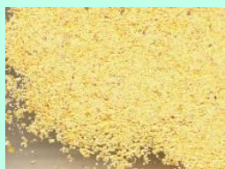
Amostra representativa de milho com granulometria referente à peneira de 20 mesh (0,85mm)
