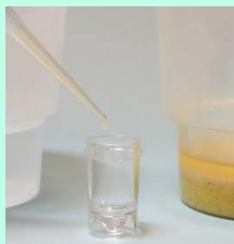
Adicionar o Tampão ao tubo de reação; em seguida o extrato; misturar bem com a ponta da pipeta
