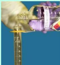
*Medir o solvente e adicionar à amostra triturada*
