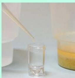
*Adicionar o Tampão ao recipiente primeiro, então adicionar o extrato; misturar bem com a ponteira da pipeta*
